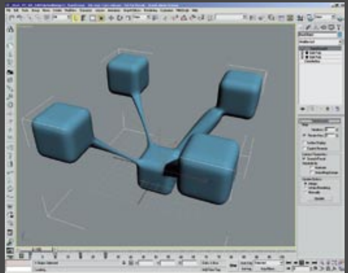
[10] Hier sehen Sie das vorläufige Ergebnis unserer animierten Edit Poly Modifier, bereits mit dem neuen TurboSmooth Modifier versehen
