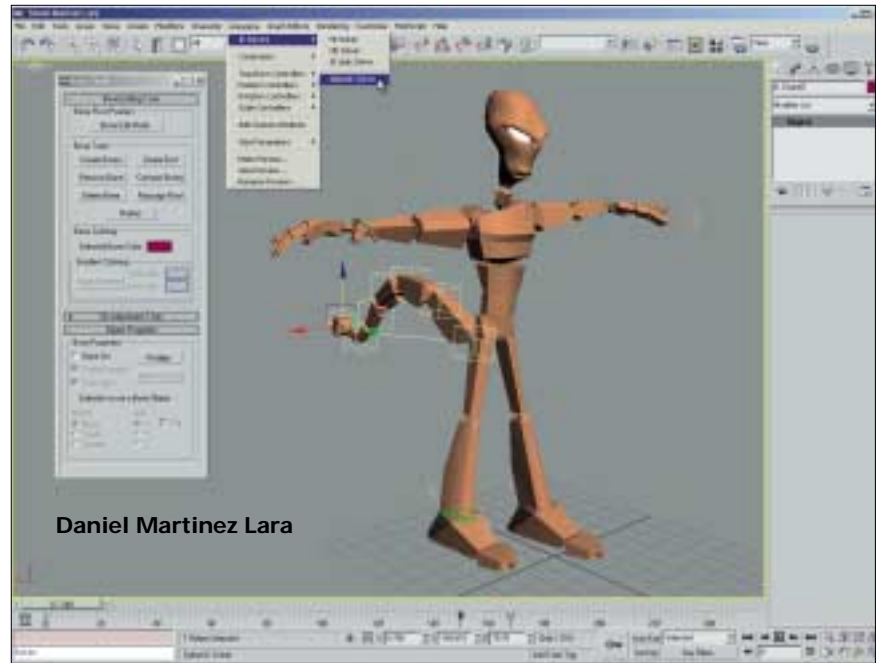
Die Spline-IK kann eine größere Anzahl von Bones über nur eine einzelne Curve kontrollieren. Hier sehen wir neben dem geöffneten Bone-Tools-Editor, an welcher Stelle im User-Interface diese neue Funktion zu finden ist
